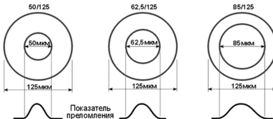
Рис. 2.2.2. Стандартное градиентное многомодовое волокно с диаметром сердцевины 50 мкм (а), 62,5 мкм (б) и 85 мкм (в)
