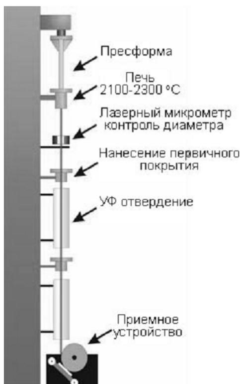
Рис.4.3.1. Установка вытяжки оптического волокна из преформы
