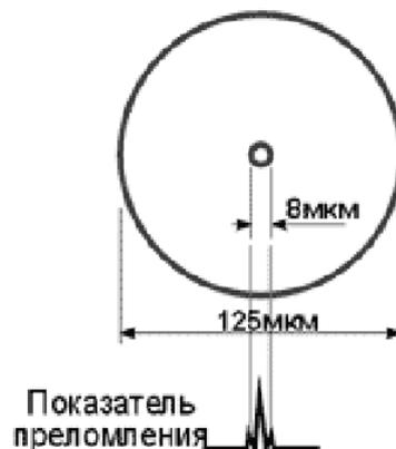
Рис. 2.2.4. Стандартное одномодовое волокно со смещенной дисперсией (DSF или NZDSF)
